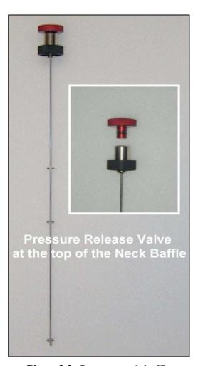
Photo 3.2. Cryostat neck baffle
