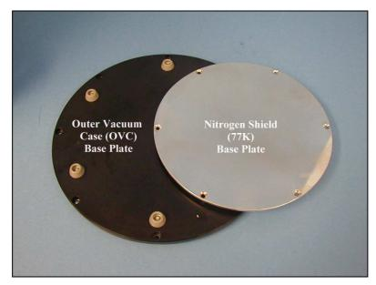
Photo 1.3. Cryostat base-plates
