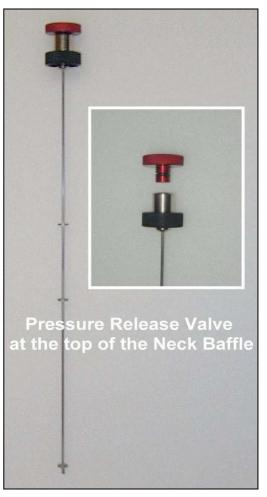
Photo 3.2. Cryostat neck baffle
