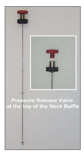
Photo 3.2. Cryostat neck baffle
