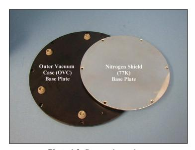
**Photo 1.3.** Cryostat base-plates
