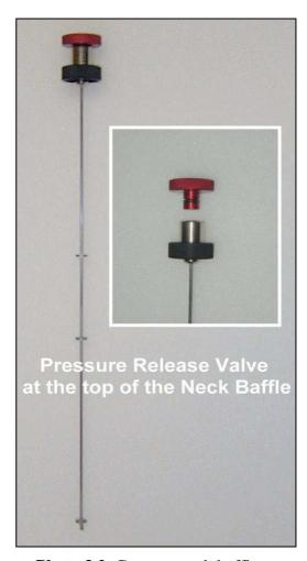
Photo 3.2. Cryostat neck baffle
